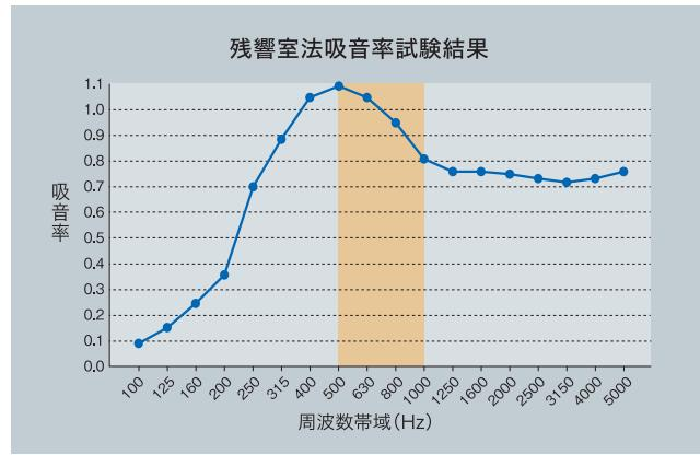
muffle+はパネルにグラスウールを内蔵することで、従来のmuffleよりも吸音性能が向上しています。人の話し声に多く含まれる周波数帯域(500～1000Hz)の吸音率が0.8以上となっています。
