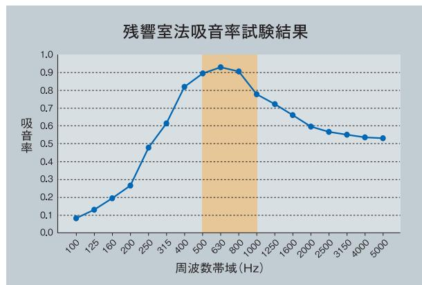
人の話し声に含まれる周波数帯域 (500~1000Hz) の吸音率が概ね 0.77~0.93と高水準の吸音性能を有しています。
