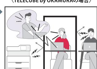
ブース内の音を抑える吸音性とブース内外の音を遮る遮音性の両方を兼ね備え、周囲を気にせずWEB会議や集中作業が行える空間を提供します。
